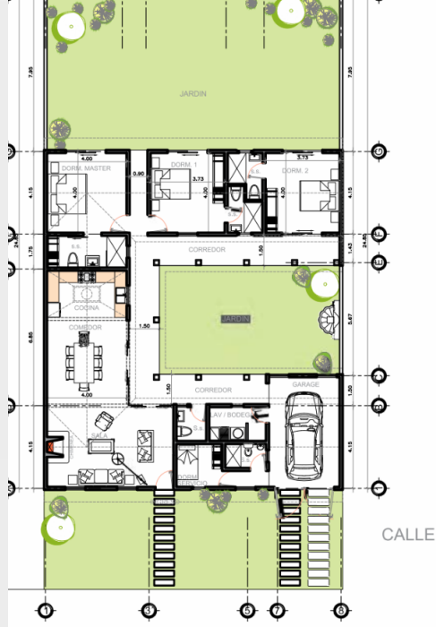
1 Planta - Arquitectonica Cortijo, Lote 19 ESCALA 1:100
